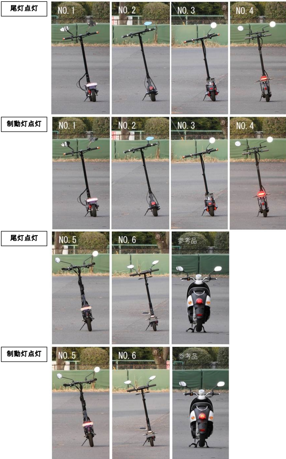
写真 18. 尾灯と制動灯の点灯の様子 (No. 1~6、参考品)
