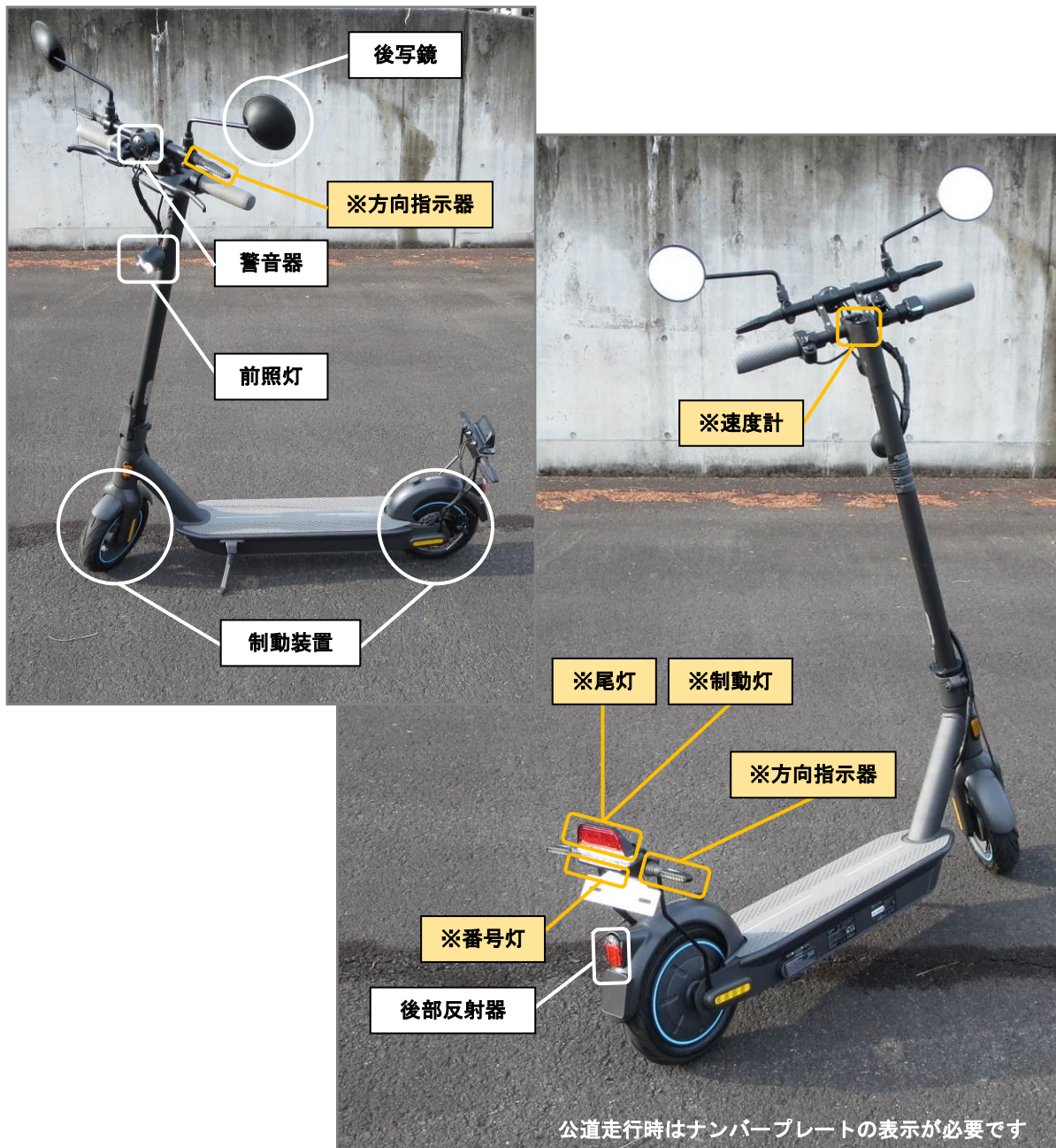
写真 2. 電動キックボード (定格出力 0.6kW 以下) に必要な主な保安装置 (10 種類)
