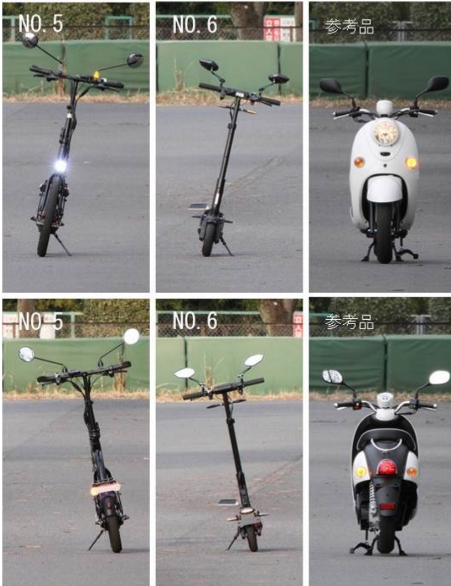
写真15. 前方と後方から見た方向指示器の点灯の様子 (No. 5、6、参考品)
